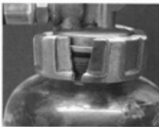
使用に耐えない破損
