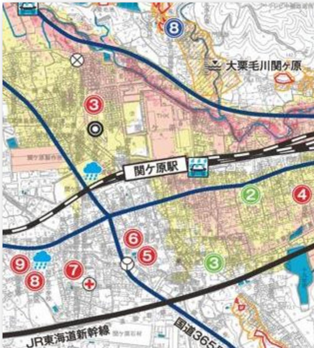
関ヶ原町には、危機管理型水位計と雨量計が各2箇所設置されています。危機管理型水位計では、河川護岸の「天端から水面までの距離」が計測され、水位情報がインターネットで公表されています。距離が短くなると、10分毎に情報が更新されます。雨量計の観測値は、「キキクル」の危険度予測などに利用されています。また、豪雨時の通行を避けるべき注意箇所（
