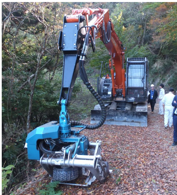
補助金により購入した林業機械（プロセッサ）
